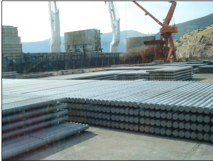
Εικόνα 10. Τελικό προϊόν (σωλήνες Al) έτοιμο προς φόρτωση.
