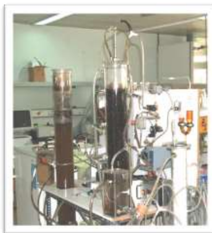
Ερευνητική μονάδα Αναερόβιας Χώνευσης
