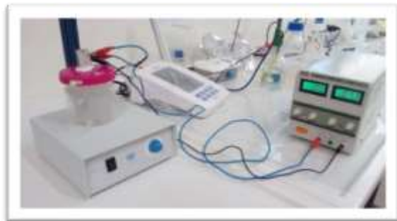
Ηλεκτροκροκίδωση πόσιμου νερού
