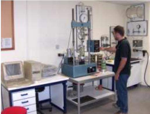
Συσκευή τριαξονικής φόρτισης για εδάφη
