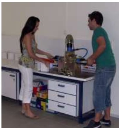
Συσκευή διάτμησης ασυνεχειών βράχων
