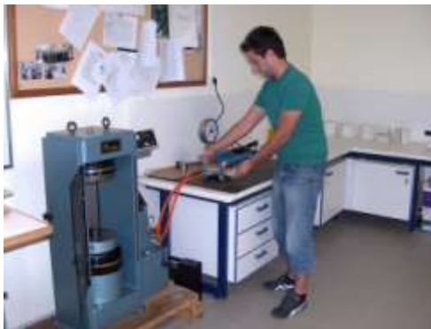
Συσκευή τριαξονικής φόρτισης για βράχους
