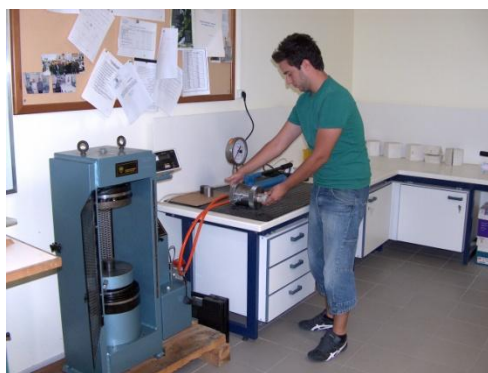
Συσκευή τριαξονικής φόρτισης για βράχους
