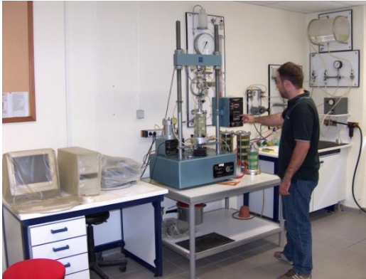
Συσκευή τριαξονικής φόρτισης για εδάφη
