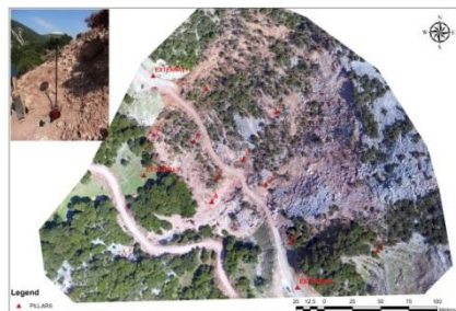
Παρακολούθηση ενεργών κατολισθήσεων με χρήση ΣμηΕΑ και δεκτών GPS (Μοίρα 2017)
