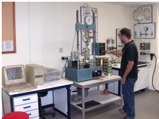
Συσκευή τριαξονικής φόρτισης για εδάφη
