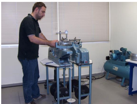
Συσκευές διάτμησης εδαφών
