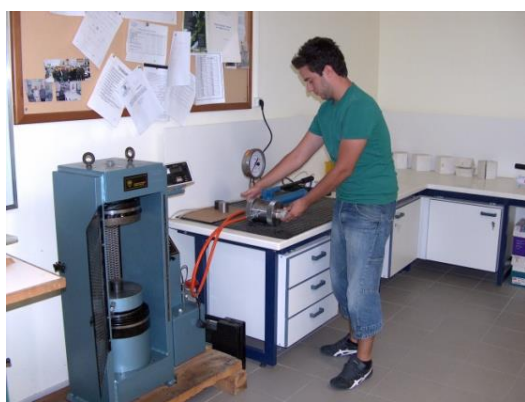
Συσκευή τριαξονικής φόρτισης για βράχους
