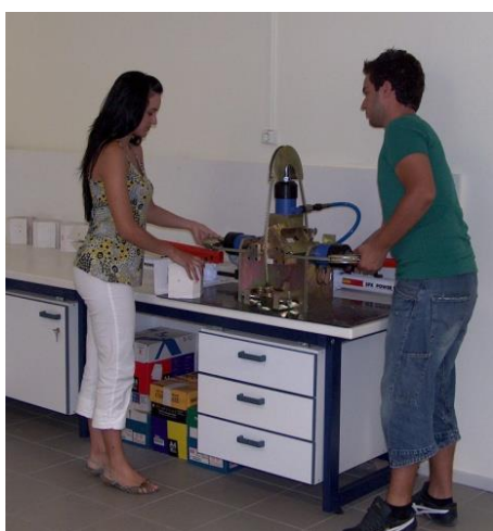
Συσκευή διάτμησης ασυνεχειών βράχων
