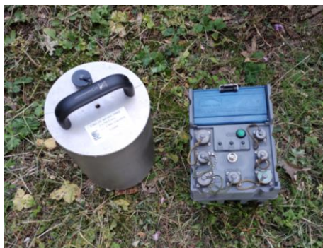
Φορητός Σεισμογράφος και Σεισμόμετρο
