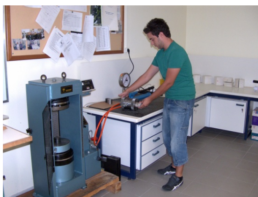
Συσκευή τριαξονικής φόρτισης για βράχους
