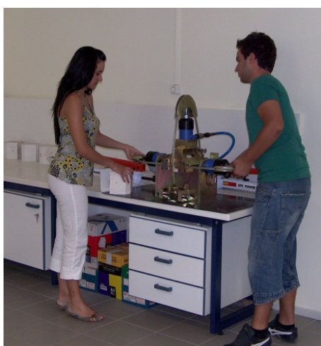
Συσκευή διάτμησης ασυνεχειών βράχων
