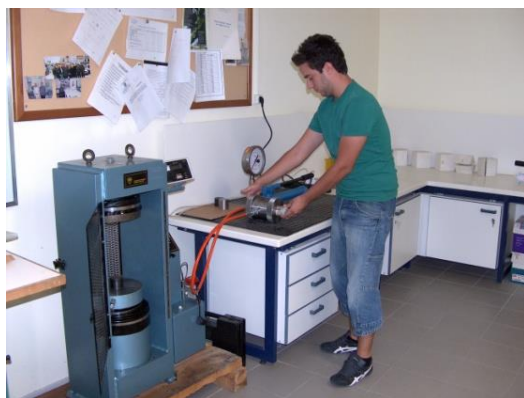
Συσκευή τριαξονικής φόρτισης για βράχους
