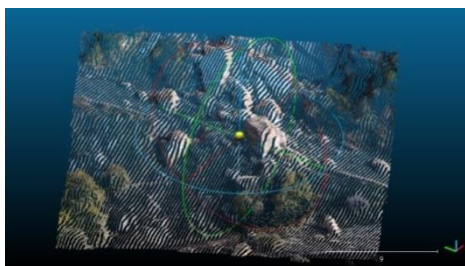
Αποτύπωση βραχοπτώσεων με TLS (Μύλοι Ηλείας 2019)
