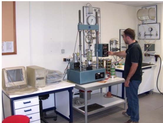
Συσκευή τριαξονικής φόρτισης για εδάφη
